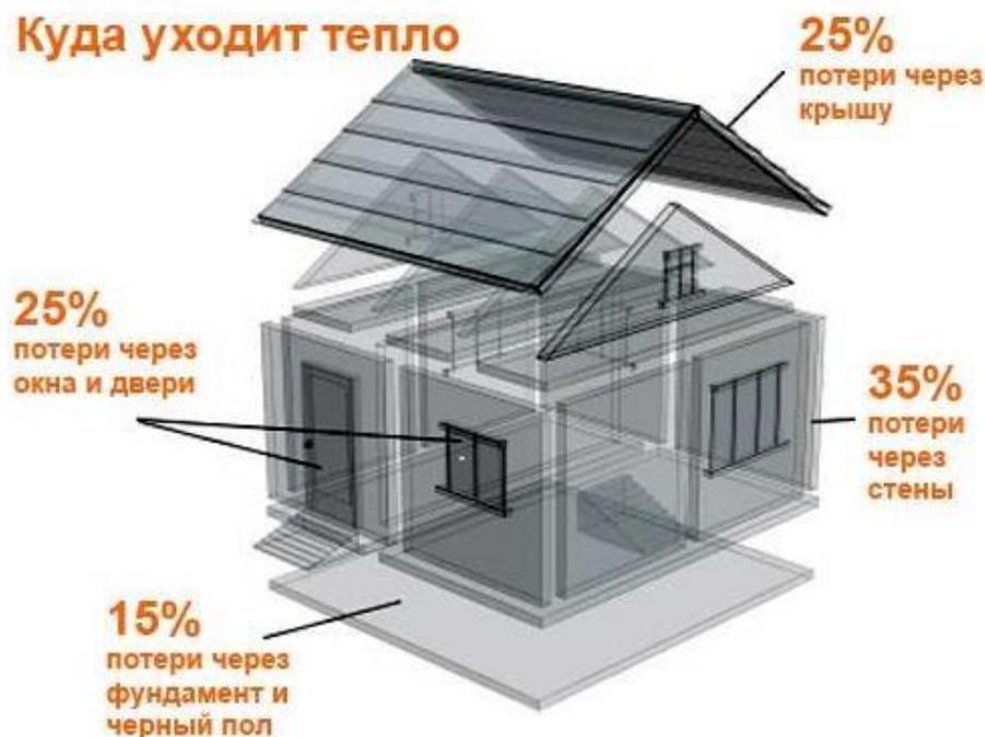
Рис.2 – Структура потерь тепловой энергии через ограждающие конструкции
